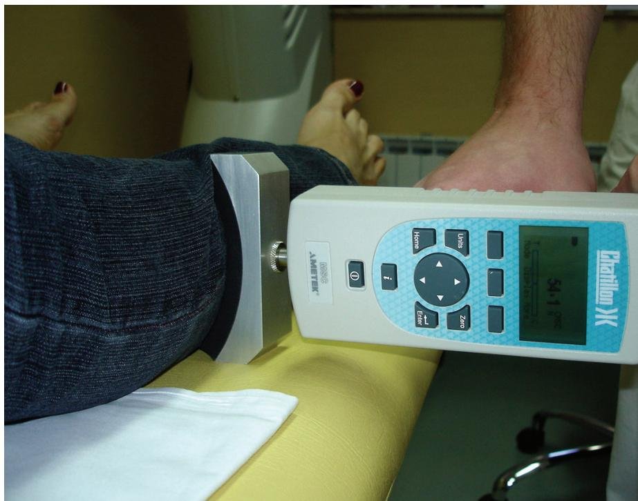
Slika 3.9 Primjer mjerena snage mišića Chatillon dinamometrom.
